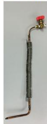
(d) L-shape air cooled thermosyphon (HP5)
