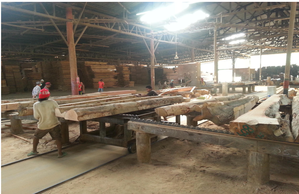
图十：将切割好的木桐开始进行木板切割
