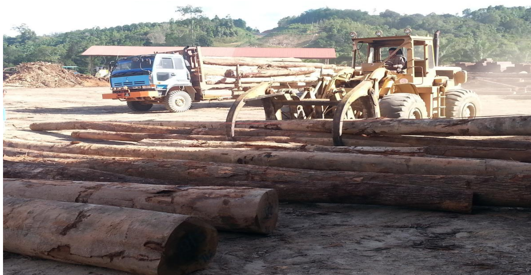
图二：WHEEL LOADER 966 CATERPILLAR 将木桐一根根的运下
