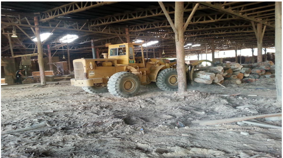
图六：由 WHEEL LOADER 966 CATERPILLAR 再次将其运去板厂里面加工
