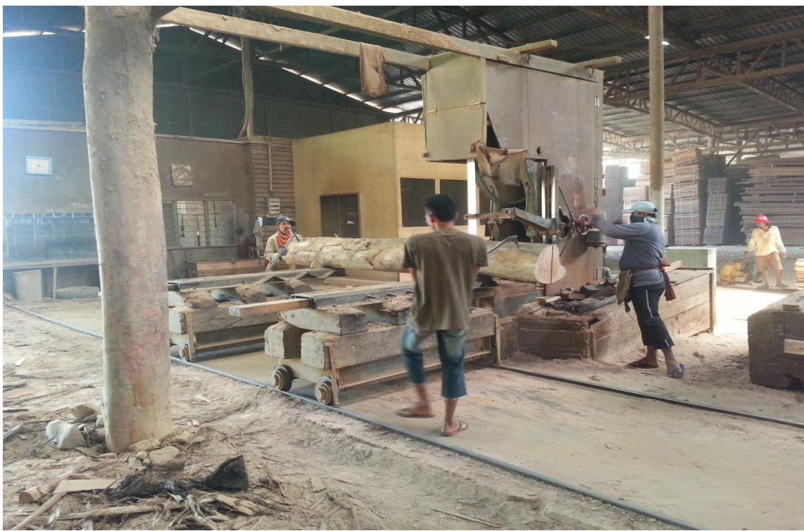
图八：员工们将木桐进行“破木”
