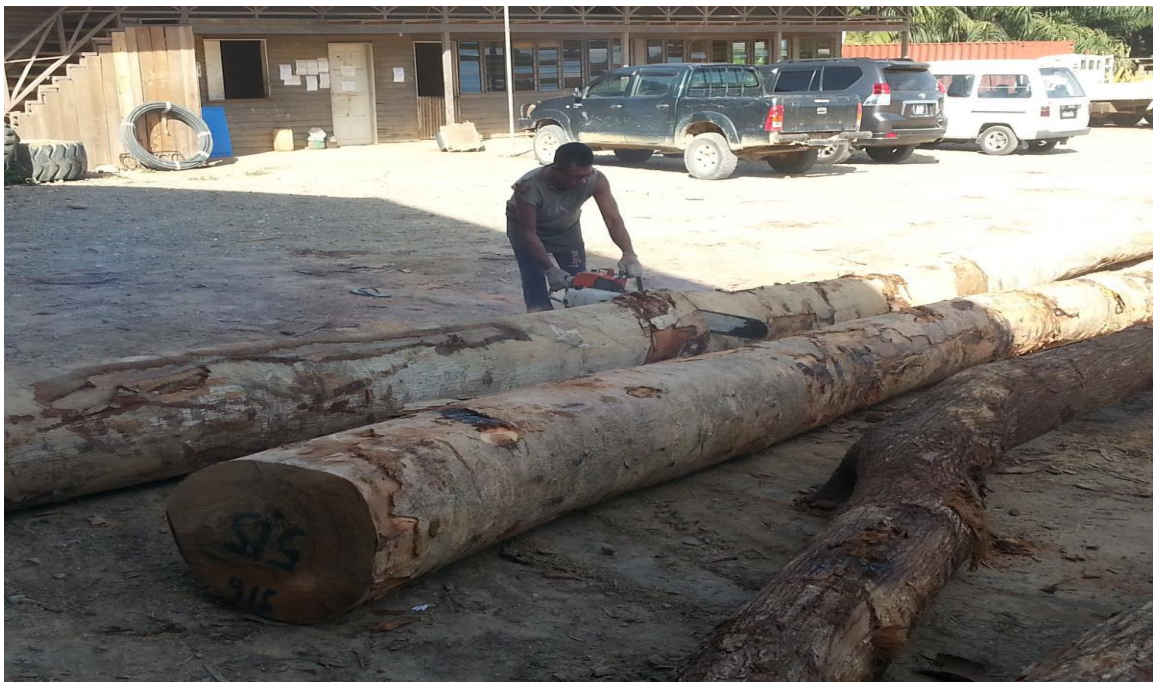
图五：锯木的工人利用 CHAINSAW 070 STHILL 将木桐一根根的根据长度锯下
