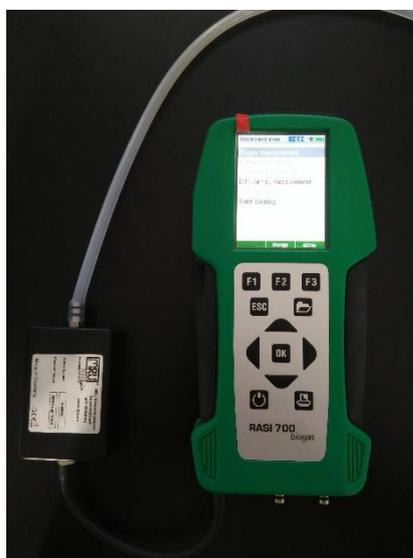
**Figure B8: Biogas Analyser (RASI 700)**
