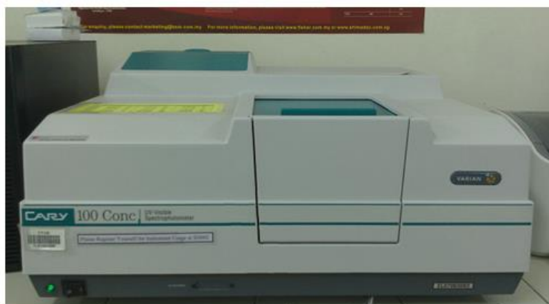
F1: Varian Cary 100 UV-Vis spectrometer
