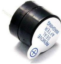
Figure 4.2.1.4.1 Mini buzzer
