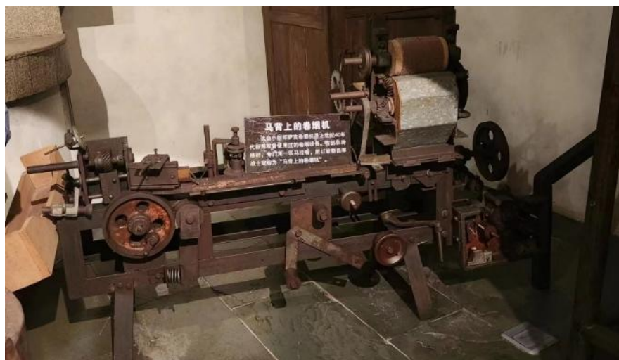
图 1.1：中国人曾用的小型邦萨克卷烟机，借助马力发动， 别称“马背上的卷烟机”。
